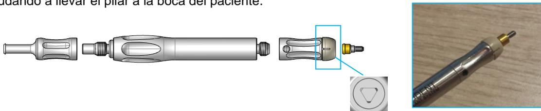
2. Para extraer un retenedor de nylon fijado en la cofia, afloje el accesorio “Extractor” (SLTM03) haciendo 2 giros completos a la izquierda (observará una brecha visible).
